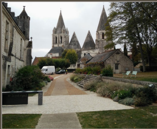
Exemple de cheminement alliant perméabilité des sols intéressante et accessibilité pour tous
